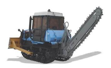
Машина землеройная цепная МЗЦ-75 предназначена для прокладки траншей для газо- и водопроводов, сетей канализации, связи и электропередачи, планировочных и земляных работ.
