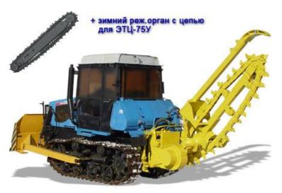
Экскаватор цепной траншейный ЭТЦ-75 на гусеничном ходу (базовый трактор производства Волгоградского тракторного завода - ДТ-75) предназначен для прокладки траншей для газо- и водопроводов, сетей канализации, связи и электропередачи в грунтах I-V категорий.
