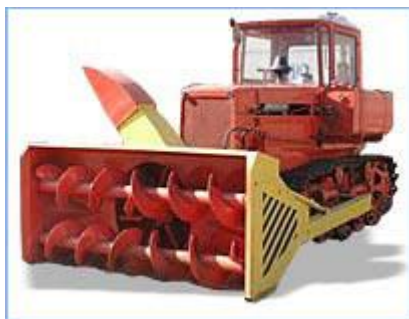
СШР 2,6 М (передний шнекоротор) Трактор ДТ-75 в сборе со шнекороторным снегоочистителем
