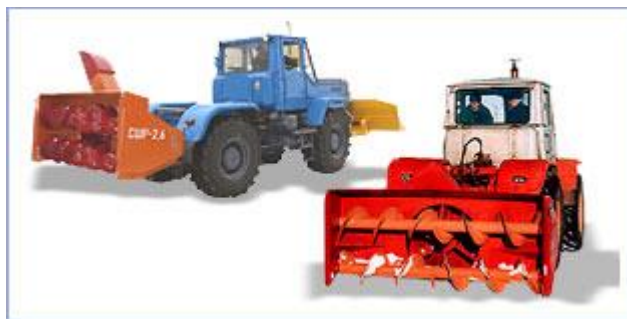
СШР 2,6 (задний шнекоротор) Трактор Т-150 (ХТЗ) в сборе со шнекороторным снегоочистителем
