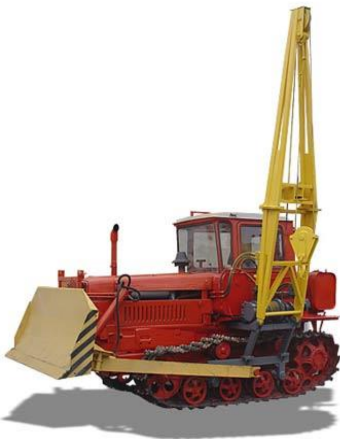
Универсальная ремонтная машина УРМ-4 (трубоукладчик) на тракторе ДТ-75.
