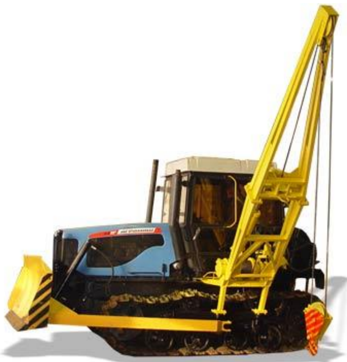
Универсальная ремонтная машина УРМ-4 (трубоукладчик) на тракторе Агромаш-90ТГ.
