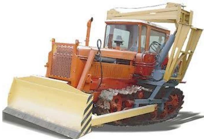
Универсальная ремонтная машина УРМ-4 (трубоукладчик) на тракторе ДТ-75. На тракторе ДТ-75 стрела складывается.
