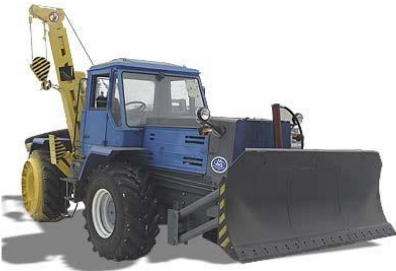
Специализированная машина для ремонтно-строительных работ СМР-3.2 на шасси ХТЗ (Т-150), дополнительно оснащенная бульдозерным отвалом
