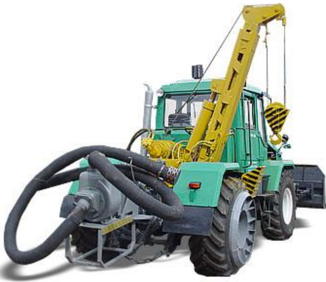
Специализированная машина для ремонтно-строительных работ СМР-3.2 на шасси ХТА (Т-150), дополнительно оснащенная водоотливной установкой
